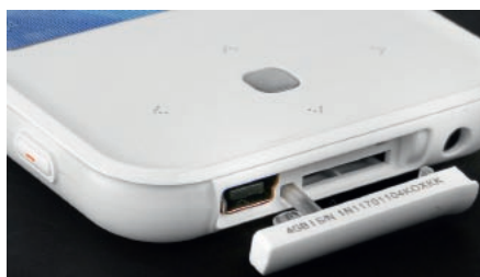
Zaślepka karty, jak i wszystkie klawisze, są bardzo szczelne i mimo iż nie jest to urządzenie wodoodporne, to na pewno kurzoodporne. Główne sterowanie odbywa się za pomocą przyciskania obudowy wokół szarego „entera”.
