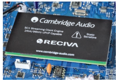
„Mózg” odtwarzacza – oprogramowana przez inżynierów CA kość firmy Reciva.
