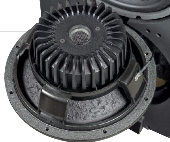
Magnesy neodymowe, jako że bardzo efektywne, są zwykle znacznie mniejsze od ferrytowych. Nie tutaj – chociaż właściwy układ magnetyczny powiększa wizualnie dodany doń radiator. Często zabezpiecza się w ten sposób magnesy neodymowe, bowiem w wysokich temperaturach neodym „traci siłę”.
