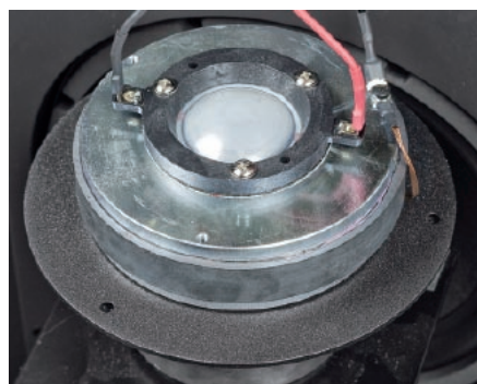
Głośnik wysokotonowy ma „zwykły” magnes ferrytowy, ale o niezwykłej wielkości (masa 3 kg). Nie tylko dzięki tubie efektywność jest tak wysoka, a silny „napęd” oznacza też bardzo dobre odtwarzanie impulsów. Kopułka z tyłu tworzy małą komorę wytłumiającą, jednak jest ona dość delikatna i w samej obudowie utworzono specjalną, dużą komorę chroniącą definitywnie wysokotonowy przed uderzeniami niskich częstotliwości.
