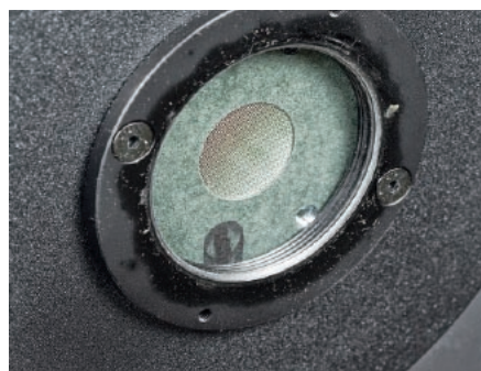
Tym razem po odkręceniu tuby nie zobaczymy samej membrany, lecz charakterystyczną dla wielu głośników tubowych metalową siateczkę, kończącą właściwy „driver”.
