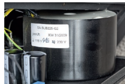
Transformator o mocy 330 VA, większej od wyjściowej mocy znamionowej wzmacniacza, potwierdza, że nie ma tu żadnej ściemy.
