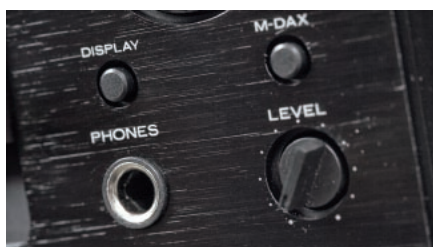
Gniazdo słuchawkowe z regulacją głośności – a za nią osobny wzmacniacz słuchawkowy.
