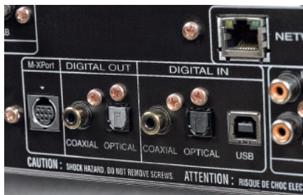
Marantz może być zarówno „transportem” cyfrowym, jak i przetwornikiem C/A. Wejścia RCA i TO-SLINK akceptują sygnał do 24/192, a USB do 24/96.
