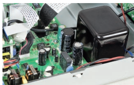
Na płytce głównej umieszczono zasilacz impulsowy, dostarczający prąd do układów cyfrowych. Obok widać zaekranowany transformator przeznaczony dla sekcji audio.
