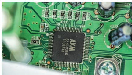
CODEC AKM z konwerterem A/D, selektorem wejść oraz odbiornikiem cyfrowym.
