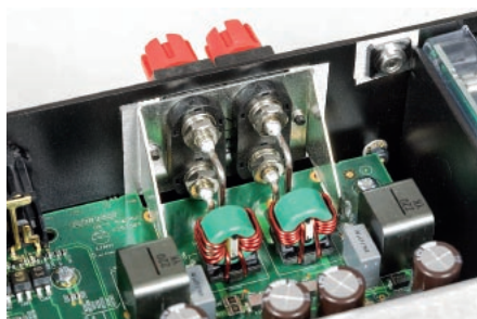
Gniazda wyjściowe, a przed nimi cewki dolnoprzepustowych filtrów rekonstrukcyjnych.
