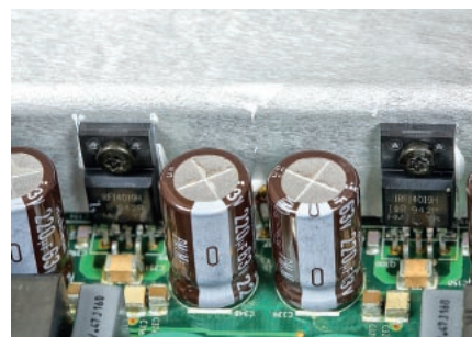
Mostki wzmacniające wzmacniacza końcowego – niewielkie, ale dobrze spełniają swoją rolę, zwłaszcza przy niższych impedancjach obciążenia.
