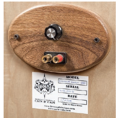
Poziom najwyższych częstotliwości, przetwarzanych przez supertweeter, możemy regulować małym pokrętełkiem nad gniazdkiem. Wraz z możliwością odwrócenia jego polaryzacji, otwiera się pole samodzielnej szlifowania brzmienia.
