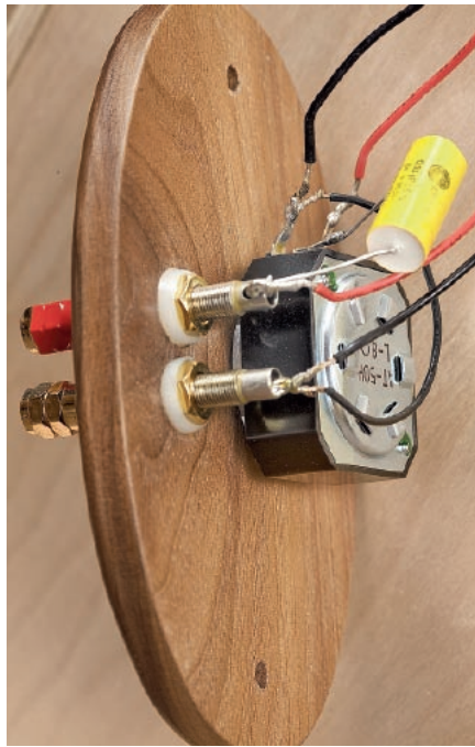
O ile głośnik szerokopasmowy może nie być w ogóle filtrowany (choć może być – a jak, czytając w głównym tekście), to głośnik wysokotonowy nie obędzie się bez filtra, przynajmniej najprostszego, takiego jak tutaj – pojedynczego szeregowego kondensatora.
