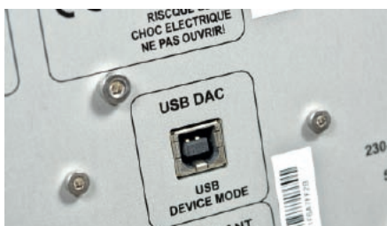
Tęgo wejścia nie mogło zabraknąć: USB, pozwalające przesyłać sygnał do 24 bitów i 96 kHz. Nie są do tego potrzebne żadne dodatkowe sterowniki, oprócz tych „zaszytych” w komputerze.
