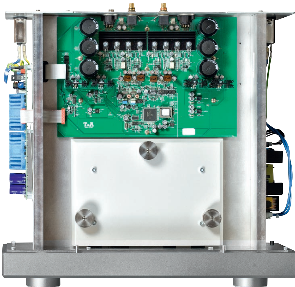
To widok z góry – z przodu oddzielona, odizolowana mechanicznie komora na transport CD, a z tyłu płytka z przetwornikiem cyfrowo-analogowym. Układy odtwarzacza cyfrowego zamontowano od spodu.
