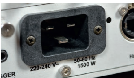
Gniazda zasilające 20 A spotyka się w audio rzadko. Kiedy jednak je widzimy, oznacza to, że urządzenie pobiera na tyle duży prąd, że zwykłe 16 A nie wystarcza do bezpiecznej pracy.
