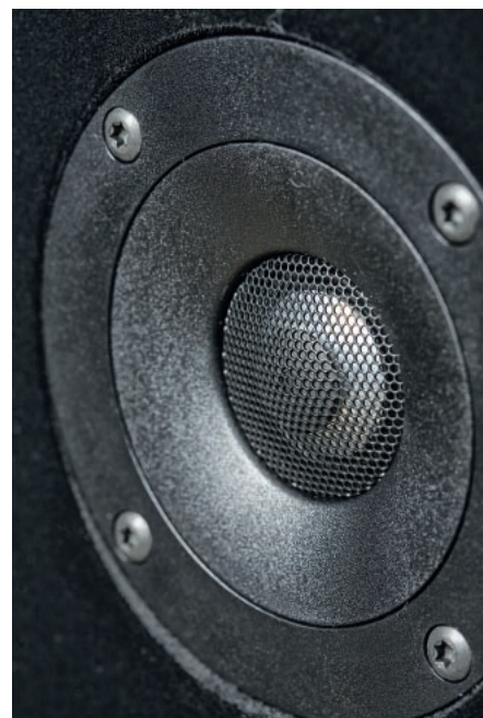
Metalowa (aluminiowo-manganowa) kopułka chroniona jest siateczką, w centrum której znajduje się mały krążek-korektor, tłumiący rezonans przy 20 kHz. Recepta sprzed lat, a wciąż skuteczna.
