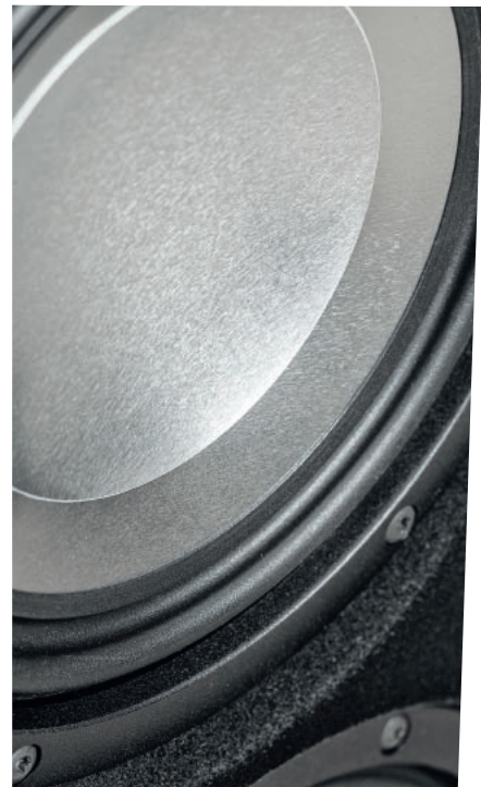
Aluminiowe membrany głośników niskotonowych usztywniono dodatkowo bardzo dużymi wklęsłymi nakładkami. Górne zawieszenie ma postać podwójnej fałdy, dostatecznie elastycznej również w zakresie niskich częstotliwości.
