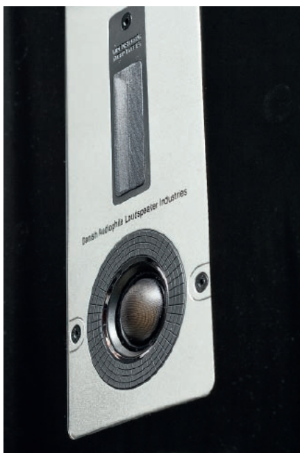
Duet kopolki i wstążki to najbardziej charakterystyczna cecha większości konstrukcji Dali – aby jednak inwestycja procentowała, układ musi być bardzo starannie zestrojony, w przeciwnym przypadku głośniki będą sobie „przeszkadzać”.
