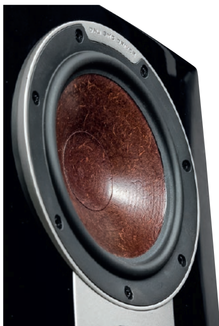
Głośniki niskotonowe i średniotonowy Epicon 8 mają membrany z takiego samego materiału, którego parametry są optymalnie wyważone dla przetwarzania szerokiego zakresu częstotliwości – z pulpy celulozowej, wzmocnionej domieszką włókna drzewnego.
