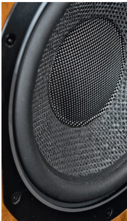
Pleciona powierzchnia membrany niskotonowej nie ujawnia jej znacznie bardziej złożonej struktury. Pojedyncza warstwa plecionki nie byłaby nawet w jednej dziesiątej tak sztywna, jak wielowarstwowa membrana Rohacell – a sztywność to w tym miejscu cecha kluczowa.
