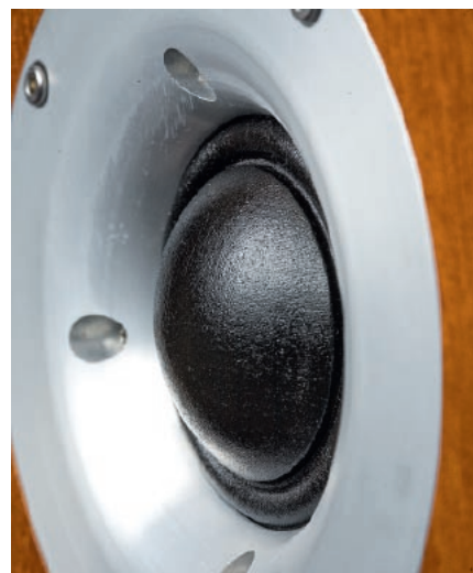
Średniotonowa kopułka jest od dawna znanym składnikiem trójdrożnych układów Pro-Aca, ale dawniej stosowana 3-calowa została zastąpiona przez 2-calową, bardziej nadającą się do współpracy ze wstęgowym wysokotonowym.
