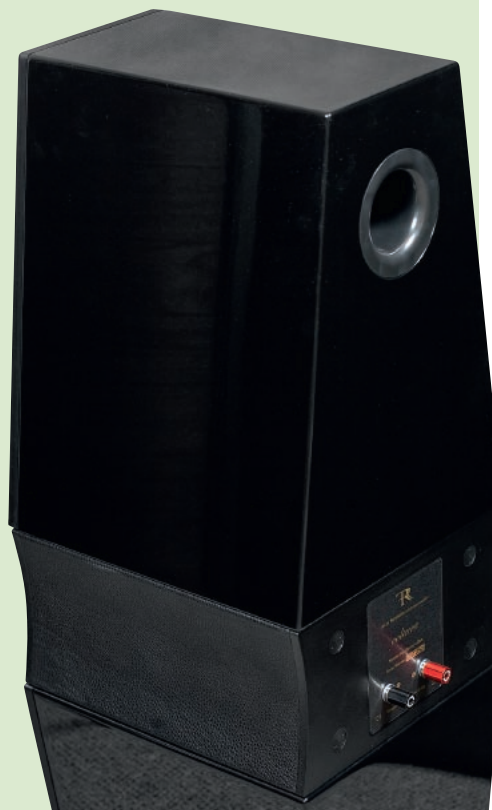
Z tyłu, w obrębie górnego modułu, znajduje się otwór bas-refleks, należący do układu rezonansowego 16,5-cm przetwornika nisko-średniotonowego; dolna „20-tka” pracuje już w obudowie zamkniętej.
