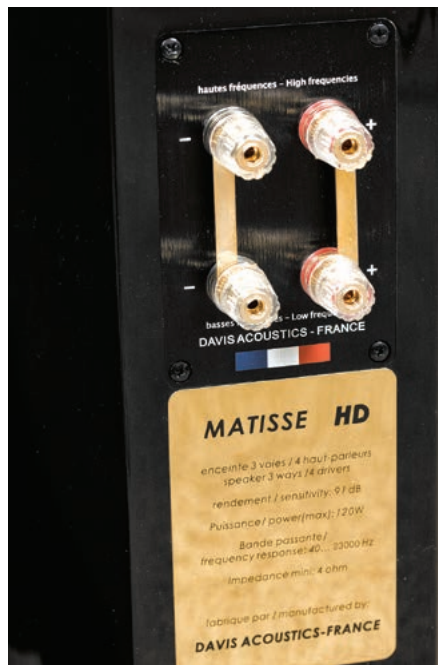
Solidne zaciski w komplecie do bi-wiringu, ale i z przyzwoitymi zworami, które pewnie częściej będą w użyciu niż podwójne okablowanie.
