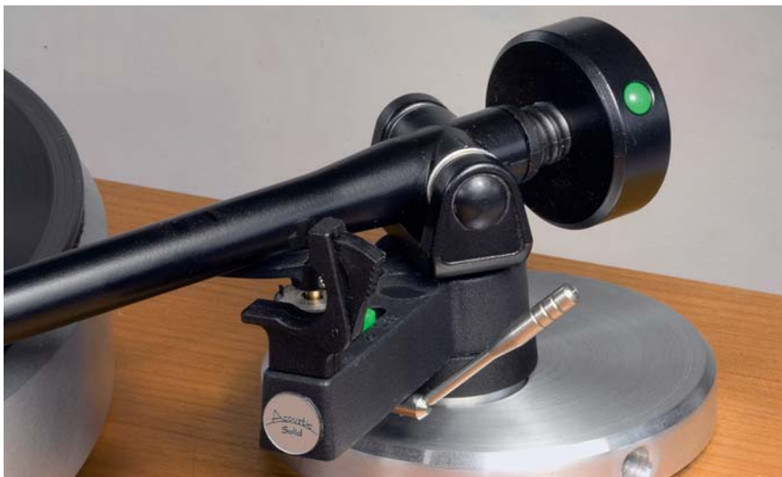
RB250 to klasyczne ramię gimballed arm, tj. podparte w dwóch punktach. Antyskating ustawia się tutaj za pomocą małych magnesów.
