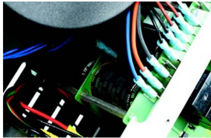
Moduł wejściowy dla gniazd XLR oraz RCA, podłączony z głównymi płytkami za pomocą solidnych kabli.
