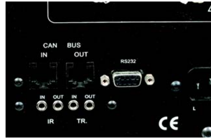
W niemal każdym urządzeniu Classe montuje rozbudowaną sekcję konektorów dla układów sterowania, w tym firmowego CAN BUS.
