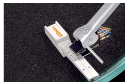
Gadżecik – klasyczna, mechaniczna waga dla wkładki.
