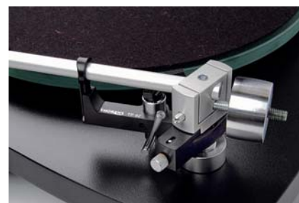
Na górze centralnego bloku widać śrubę, za pomocą której mocuje się na miejscu rurkę – dzięki temu można ustawić overhang i azimuth.
