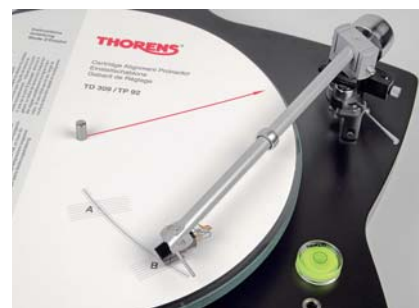
Na górze centralnego bloku widać śrubę, za pomocą której mocuje się na miejscu rurkę – dzięki temu można ustawić overhang i azimuth.
