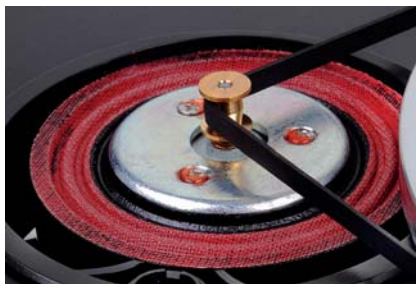
Silnik asynchroniczny DC zawieszony jest na dwóch sprężystych elementach, takich samych jak dolne zawieszenie głośnika.
