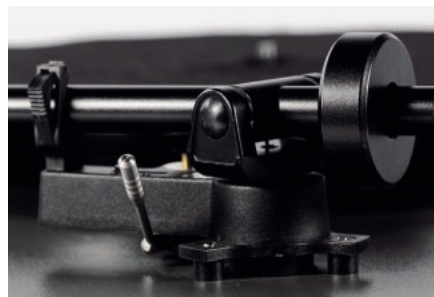
Przeciwwaga to płaski krążek, który dosuwa się do kryzy. Kardanowe zawieszenie to obracająca się w łożysku „klema”.
