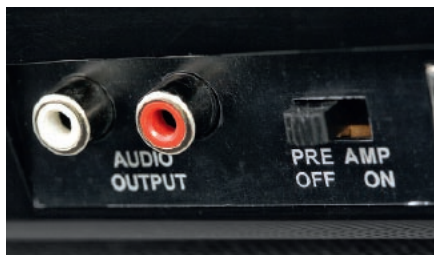
Zamiast wiszących kabli – złącza RCA. Wreszcie możemy zastosować własny interkonekt, obok wyjścia hebelek pozwalający odłączyć wbudowany przedwzmacniacz korekcyjny
