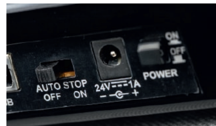
Lenco ma układ automatycznego stopu, który można odłączyć.
