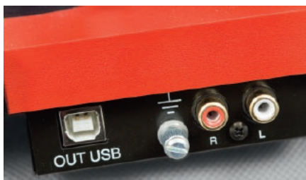
Prosty i wygodny panel połączeniowy - wyjście USB, para porządných gniazd RCA i trzpień uziemiający.
