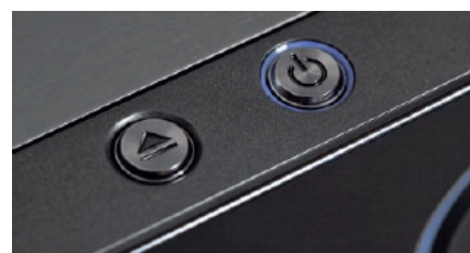
Aby nie brudzić błyszczącego frontu, klawisze sieci i wysuwania płyty przeniesiono na górną krawędź.
