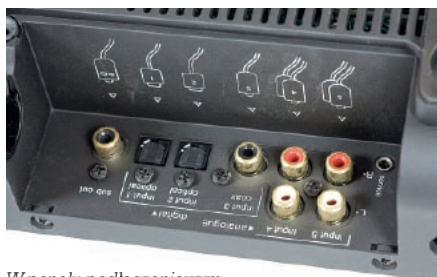
W panelu podłączeniowym przygotowano dwa standardy wejść cyfrowych i parę analogową – wszystkie RCA mają złocone styki.
