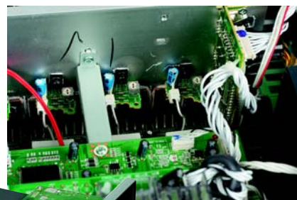
Na radiatorze znowu znajdziemy tranzystory Sanken, a nieco wyżej solidne uzebrowania mocujące płytki drukowane.
