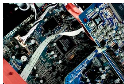
W sekcji audio wykorzystano nowoczesny dekodery surround Cirrus Logic z zaszytymi algorytmami korekcji akustyki i THX Ultra2.
