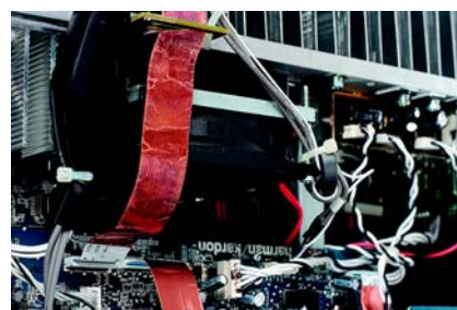
Do efektywnego chłodzenia końcówek mocy potrzebne były aż dwa duże wentylatory.
