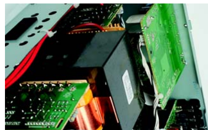
Gniazda HDMI zainstalowano w ostatnim kawałku wolnej przestrzeni, niestety tuż obok transformatora zasilającego.
