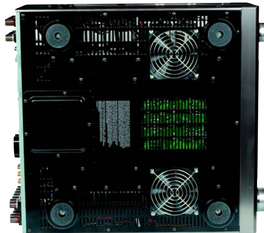
Tajemnica skutecznego chłodzenia DSP-Z11 – dwa duże wentylatory umieszczone na linii końcówek mocy.
