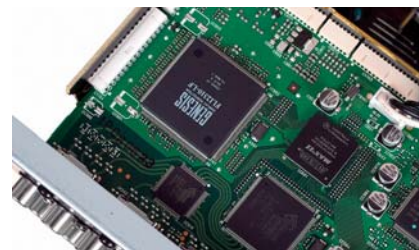
Procesor wizyjny Genesis FLI2310 zajmuje się między innymi skalowaniem do 1080p.
