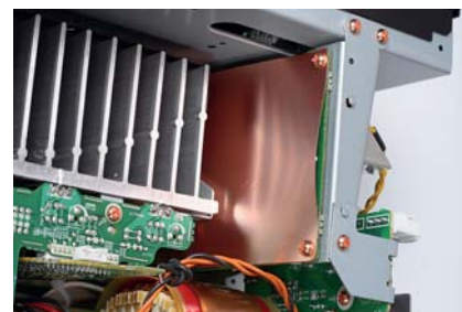
Elementy zasilacza zostały zaekranowane.
