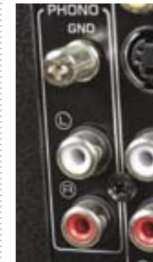
W obydwu amplitunerach, wśród wejść analogowych, jest gniazdo dla gramofonu analogowego (MM).
