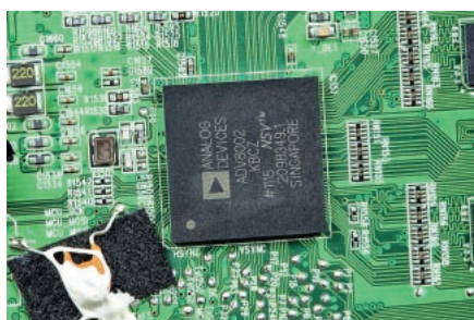
Firma Analog Devices dostarczyła także świeżutki (premiera na początku roku) procesor obrazu, łączący w jednej obudowie funkcje skanera i generatora grafiki ekranowej.
