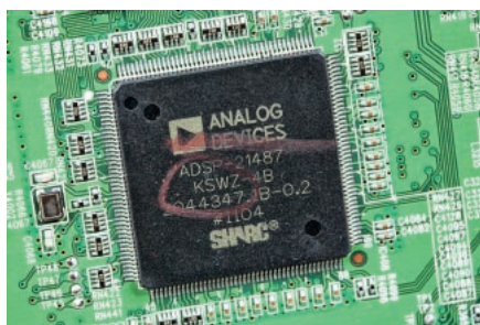
Analog Devices Sarc – te procesory DSP realizują obróbkę sygnałów audio.
