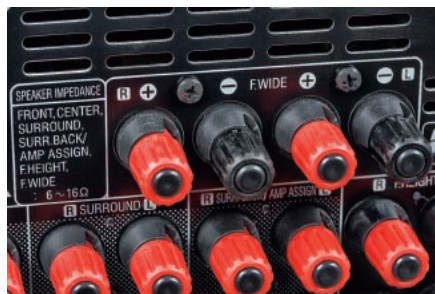
Dodatkowe terminale wyjściowe służą do realizacji rozbudowanych konfiguracji głośnikowych z efektywnymi kanałami w systemie Audyssey DSX.
