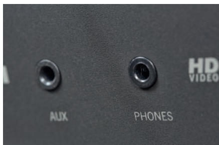
Wejście podręczne bardzo skromne – oprócz gniazda słuchawkowego tylko złącze dla sprzętu przenośnego.
