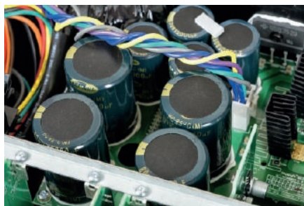
Klasyczny analogowy wzmacniacz wymaga wydajnego zasilacza i baterii kondensatorów filtrujących.
