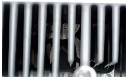
Do chłodzenia został wykorzystany wentylator schowany pod radiatorem.
