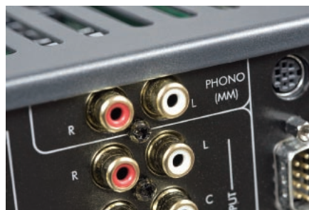
Wszystkie wejścia analogowe są złączone, gniazdo dla gramofonu ma jednak zawsze szczególne znaczenie.
