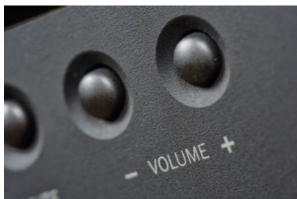
Z frontu wyeliminowano pokrętkę, funkcje regulatora głośności przejęły dwa przyciski.
