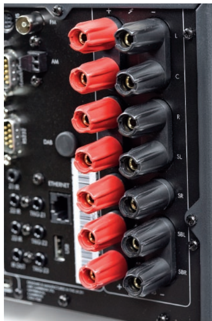
Siedem końcówek mocy i „tylko” siedem terminali głośnikowych, za to do każdego można bez obaw podłączyć 4-omową kolumnę.
