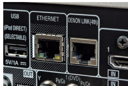
Interfejs Denon Link opracowano w celu najwzrostniejszego przesyłania sygnałów DVD-Audio i SACD, standard połączenia jest podobny do LAN.
