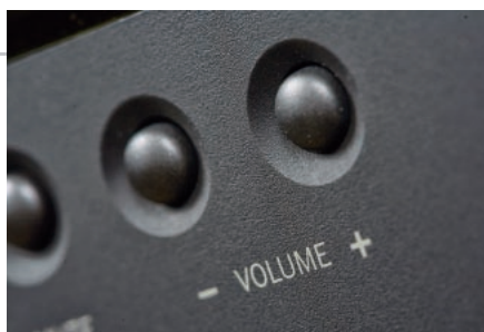
Zamiast pokrętła głośności, w ciąg przycisków wkomponowano dwa klawisze do regulacji wzmocnienia.
