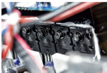
Elementy mocy z serii ThermalTrak są wykorzystywane również w droższych urządzeniach Arcama.
