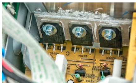
Końcówki mocy zbudowano z tranzystorów firmy Toshiba.
