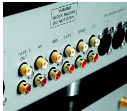
PRE30 to urządzenie w pełni zbalansowane – stąd i wejścia, i wyjścia XLR. Ale standardowych łącz RCA też nie zabraknie.
