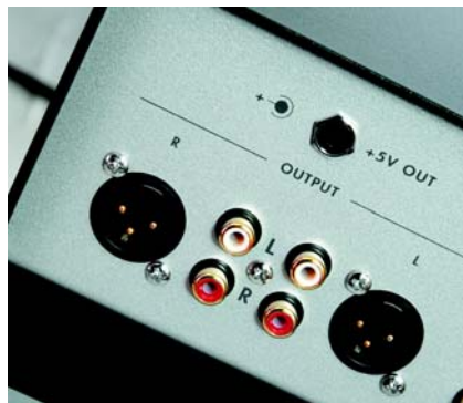
Do dyspozycji jest para wyjść XLR oraz dwie pary niezbalansowanych wyjść RCA.
