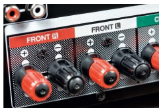
Nowa aranżacja terminali głośnikowych i kolorowe naklejki do oznaczenia kabli pomogą opanować temat.
