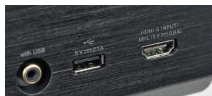
Komplet HDMI / USB uzupełniono protokołem MHL dla tego pierwszego oraz dodatkowym gniazdem wideo kompozyt dla drugiego.
