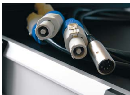
Wtyki zastosowane w zasilaczu to arystokracja – Powercony szwajcarskiego Neutrika.
