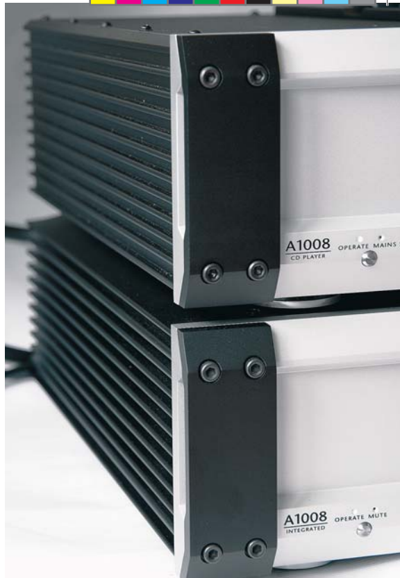
Widoczne z boku radiatory są prawdziwe tylko we wzmacniaczu, w przypadku odtwarzacza są elementem dekoracyjnym, ale nie można im odmówić udziału w usztywnieniu obudowy.
