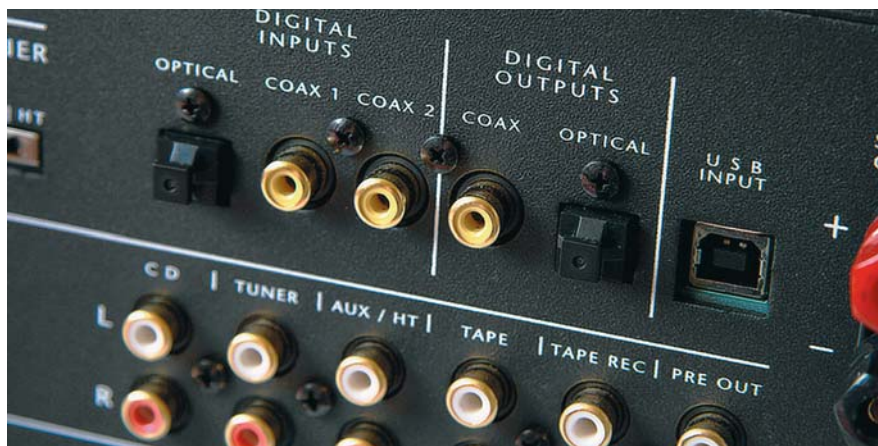
Wzmacniacz wyposażono w kompletny przetwornik C/A z upsamplery. Stąd obecność wejść i wyjść cyfrowych.
