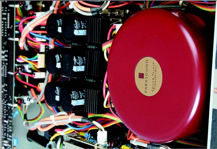
Transformator zasilający w puszcze ekranującej.
