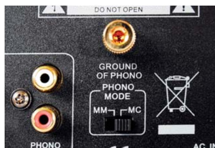
MAP-105 jest wyposażony w przedwzmacniacz gramofonowy MM/MC.
