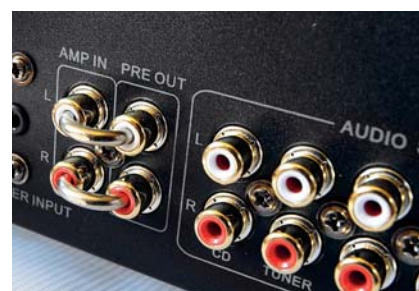
Przedwzmacniacz z końcówką łączy zwory na tylnej ścianie.
