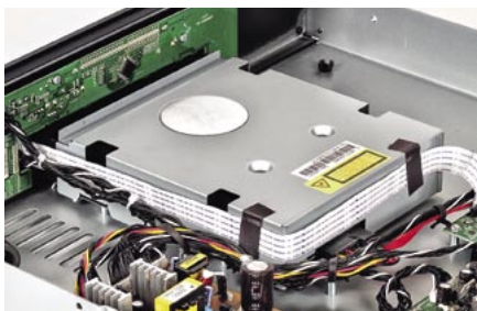
Napęd BD-ROM - w metalowej konstrukcji pełniący rolę klatki Faradaya.
