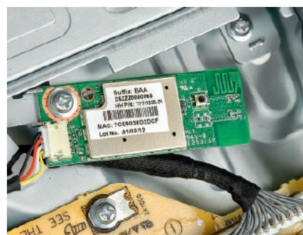
Niewielki moduł jest kompletnym odbiornikiem sieci Wi-Fi.
