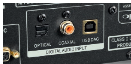
Jednym z wartościowszych wejść jest asynchroniczne USB, pozwalające na przesyłanie sygnałów z komputera.
