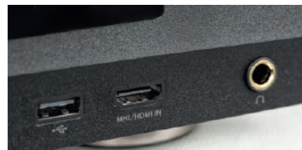
Oprócz wejść USB i podręcznego HDMI (z dodatkiem MHL) jest również wyjście słuchawkowe z dedykowanym wzmacniaczem.
