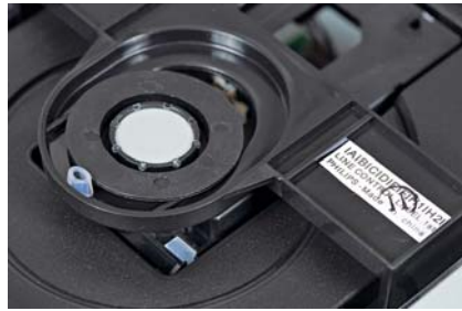
Napęd VAM 1202/12 - chociaż już nie produkowany przez Philipsa, wciąż jest spotykany.
