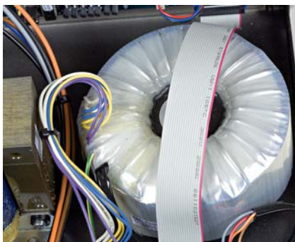
...napięcia zasilającego dostarcza już trafo toroidalne.
