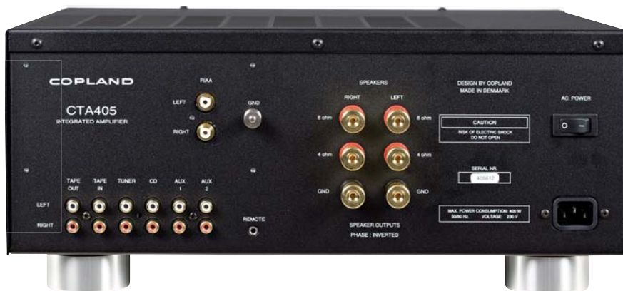
Typowe wyposażenie wzmacniacza lampowego - z niezależnymi odczepami transformatorów wyjściowych. Gniazda wyjściowe - oryginalne zaciski WBT.
