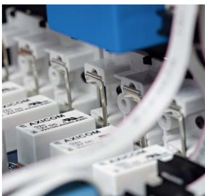
Selekcja wejść to już zadanie dla nowoczesnych przekaźników sterowanych z układu cyfrowego.
