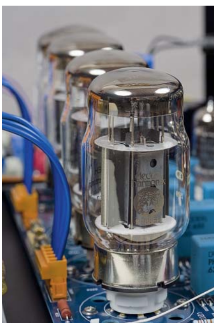
Tetrody KT88 dostarczają 50 W mocy na kanał.
