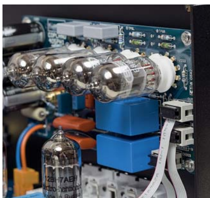
Nawet w obszarze korekcji dla gramofonu analogowego zatrudniono bańki.
