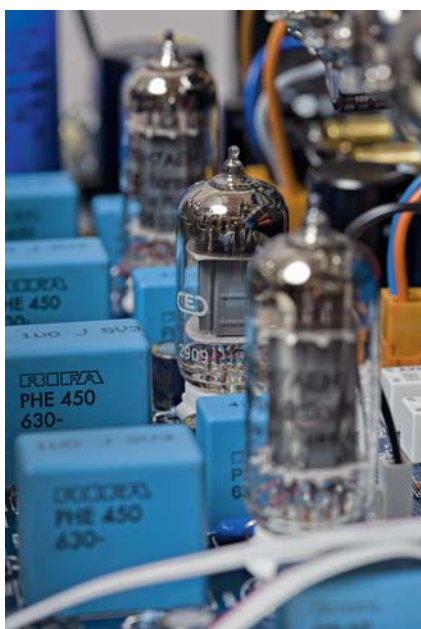
Również przedwzmacniacz jest układem lampowym.
