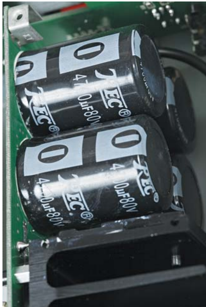
Pojemności filtrujące zasilacza przesunięto na modul każdej z końcówek.
