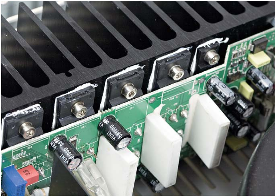
Końcówki mocy, na każdej 8 tranzystorów, widoczna tylko połowa.
