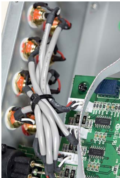
Sygnal z wejść RCA płynie na płytce przedwzmacniacza ekranowanymi przewodami.
