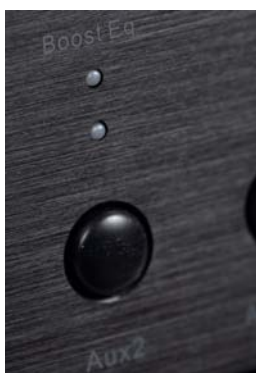
Przedwzmacniacz zaopatrzone w układ Bass EQ, pomagający wykrzesać z małych głośników więcej basu.
