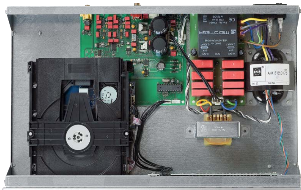
Praktycznie wszystkie układy audio poukładano na jednej drukowanej płytce, dużo miejsca zajmuje zasilacz.
