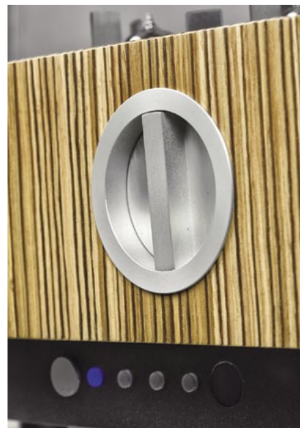
Gałka siły głosu, a właściwie przełącznik z dwoma skrajnymi położeniami, wraca do punktu spoczynkowego.
