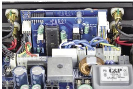
Płytki z wejściami i układem logiki. Tutaj montuje się opcjonalną kartę dla wejść USB z przetwornikiem C/A.
