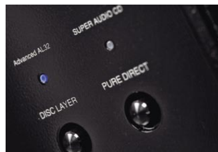
Przycisk „Pure Direct” wyłącza wyjścia cyfrowe i wyświetlacz.
