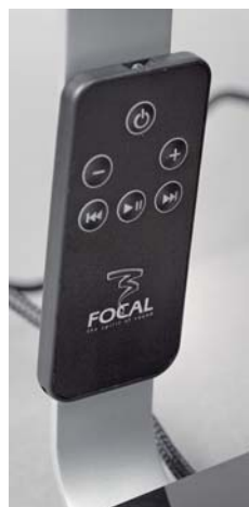
Mały pilot mocowany jest magnesem na ramie głośnika.
