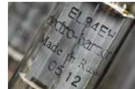
EL84EH – pentoda mocy, nie przez wszystkich audiofilów považana... To błąd! Jak pokazują liczne przykłady, zastosowana właściwie zapewnia świetny dźwięk; w AM-201 pochodzi z produkcji Electro-Harmonixa.
