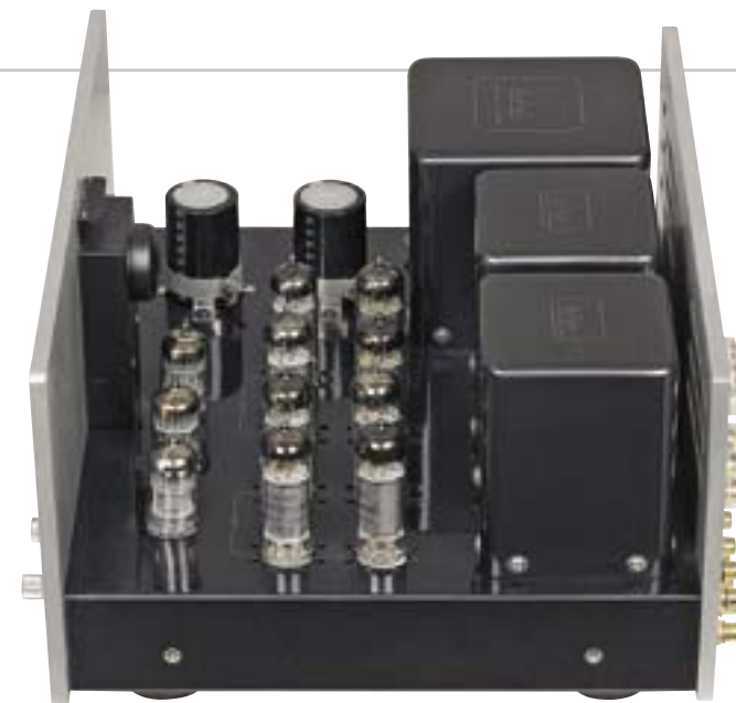
Po zdjęciu drewnianej osłony widać klasyczną budowę urządzenia.
