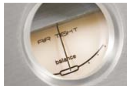
Wskaźnik biasu skojarzony z przełącznikiem na przedniej ścianie. Punkty pomiarowe oraz regulację schowano pod ściąganą drewnianą osłoną.
