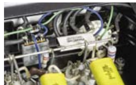
Selektor wejść jest mechaniczny, obok widać tłumik Alpsa; wejściowy kondensator sprzęgający to drogi RealCap.
