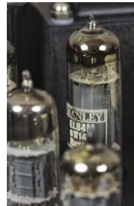
Na wyjściu pracują EL84: Manley stosuje selekcyjonowane lampy Sovteka NOS z zapasów wojskowych - stąd w oznaczeniu literka „M”.
