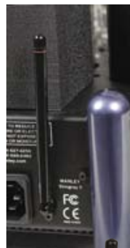
To nie jest antena Wi-Fi, ale odbiornik radiowy dla pilota.
